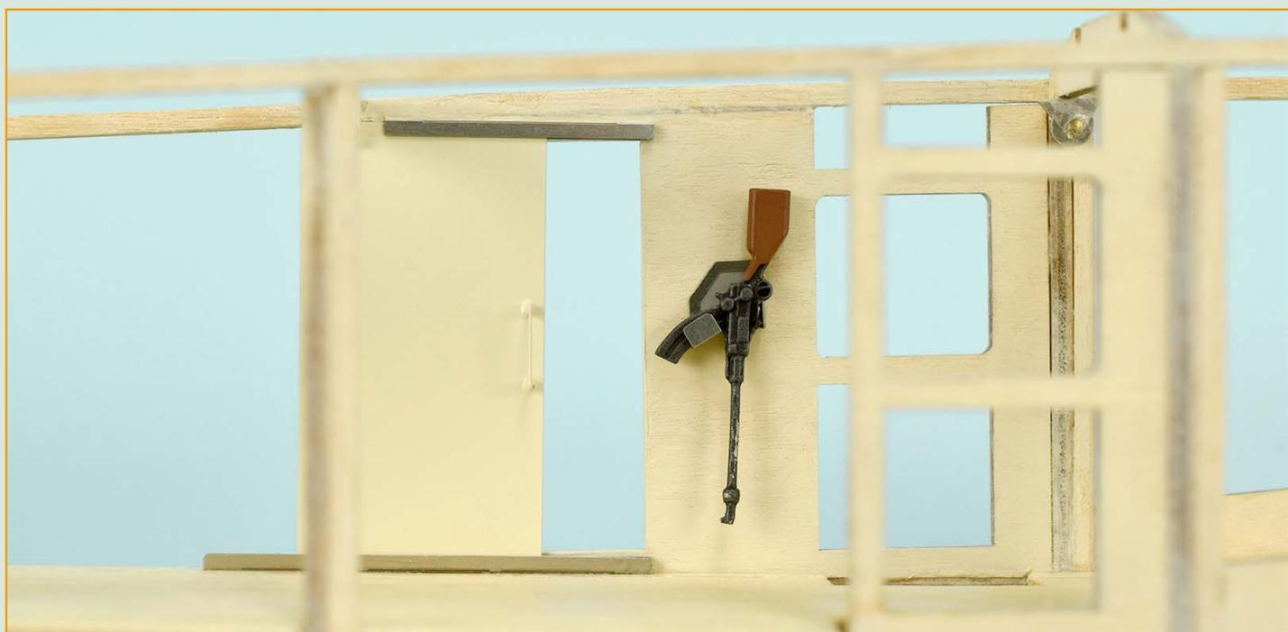
**25** Приклейте держатель с пулеметом к боковой стенке кабины справа от дверного проема, как показано на снимке.
