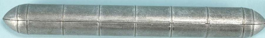
**31** Склейте друг с другом половинки бензобака. Для достижения наилучшего результата сначала соедините их без клея с помощью струбцин, тщательно выровняйте, а затем аппликатором внесите клей встык по всему периметру. После высыхания клея обработайте бак наждачной бумагой для зачистки места склейки и получения ровной и гладкой поверхности.
