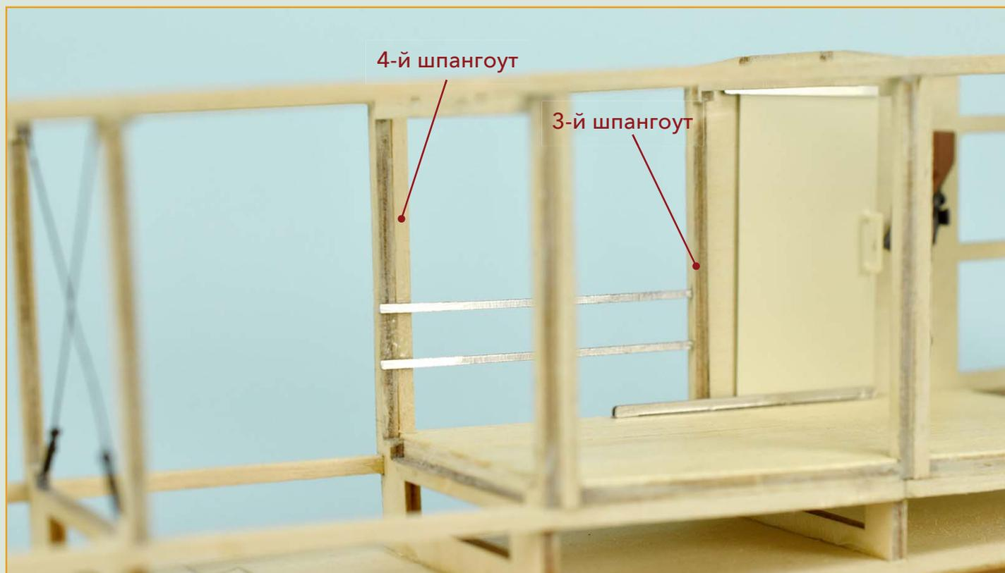
**26** Возьмите алюминиевые полоски, которые вы получили с 5-й посылкой, и отрежьте от них два фрагмента длиной по 50 мм. Приклейте их изнутри фюзеляжа между 3-м и 4-м шпангоутами параллельно друг другу и полу кабины, как показано на снимке. Затем обрежьте концы, выступающие за 4-й шпангоут.
