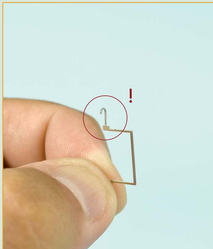
**34** Плоскогубцами отогните вбок на 90° дренажную трубку в верхней части кронштейна F10.
