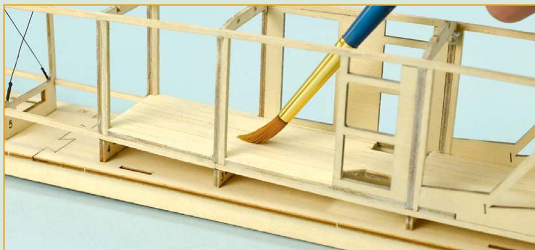
**9** После высыхания клея покройте пол кабины слоем прозрачного лака.
