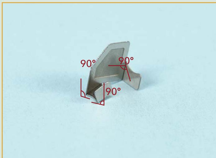
**23** Извлеките из заготовки деталь F1 (держатель пулемета), зачистите ее края и согните с помощью плоскогубцев, как показано на снимке.
