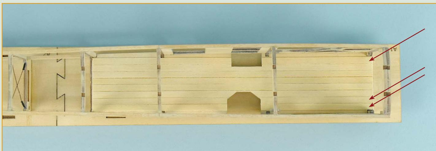
**7** Добавьте еще одну ленту шпона слева и две — справа. Также обрежьте концы и до конца прорежьте люки.
