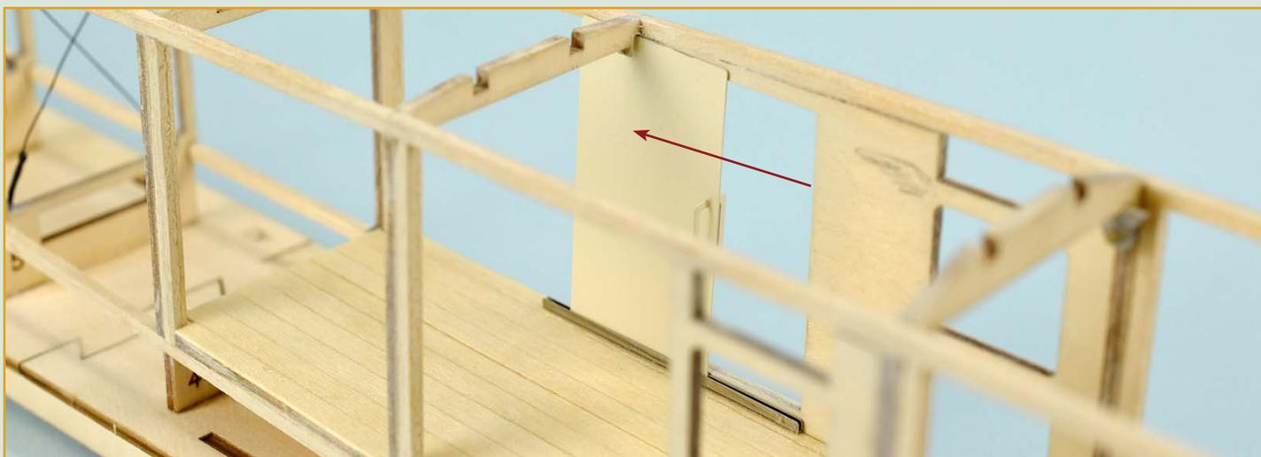
**18** Еще раз проверьте, как дверь движется по нижней направляющей. При необходимости углубите пропил в шпангоуте.
