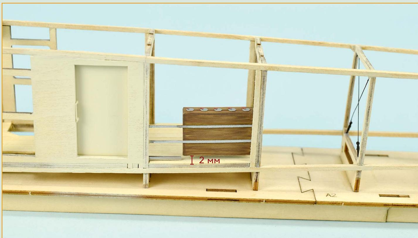
**27** Ориентируясь по снимку, приклейте к полоскам бомбовую кассету, которую вы получили с 7-й посылкой. Следите за тем, чтобы она не мешала открыванию двери. Расстояние между полом и нижней кромкой кассеты должно составлять 2 мм.
