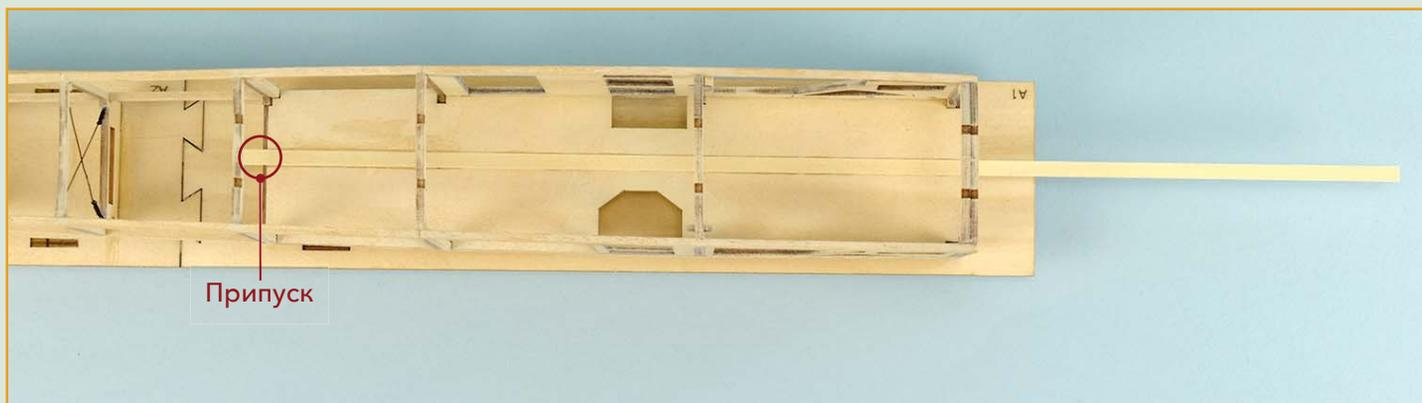
**3** Приклейте к полу полосу шпона слева от этой линии, оставив небольшой припуск сзади.
